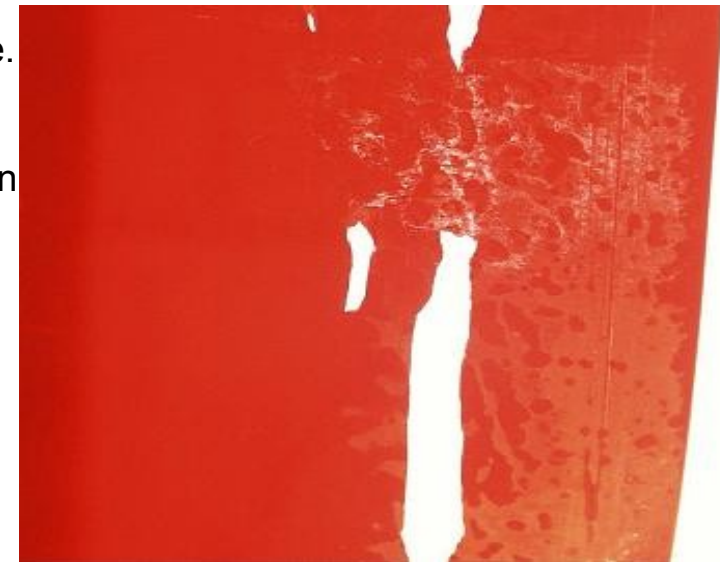
Pigmente der übereinanderliegenden Folien verkleben stärker als das Trägermaterial fest ist.
