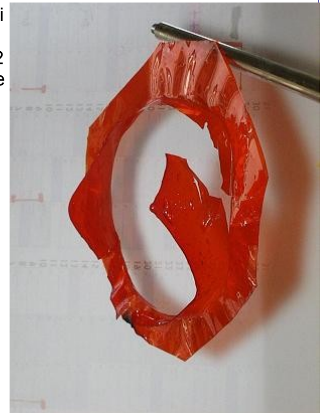
Rest einer abgetropften Folie
