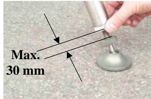
Sichern der Stellschraube
