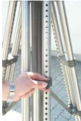
Einstellen und Sichern der Stativbeine
