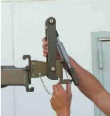
Montage des Wippen-Endstücks
