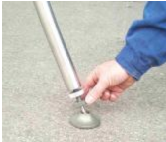
Nivellieren der Stellschraube
