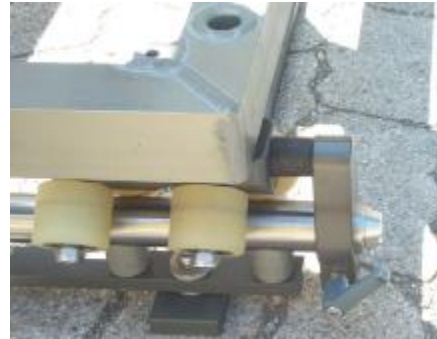
Bremsen des Schienendolly's
